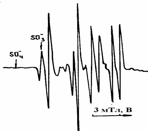
Рис.6.8. Спектр ЭПР кристалла \text{LiKSO}_4\text{-Cr}^{3+} после отжига при 200^\circ\text{C} в течение 5 мин, зарегистрированный при температуре жидкого азота. Ориентация B//a
