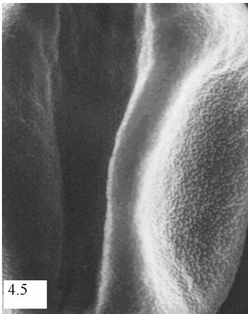
Фото 4.5-4.6 Большая степень деформации, вмятины (x 3000)
