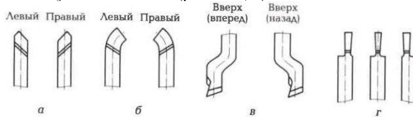
Рис. 1.4. Резцы прямые (а), отогнутые (б), изогнутые (в) и с оттянутой головкой (г)
