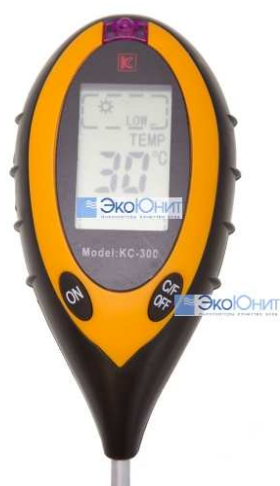
Рис 5.2. термометр щуп для определения температуры и влажности почвы
