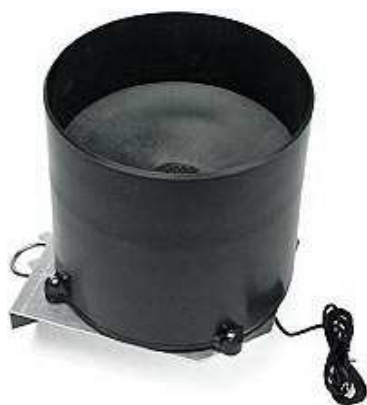
Рис 7.3. Сборник Осадков с автоопорожнением
