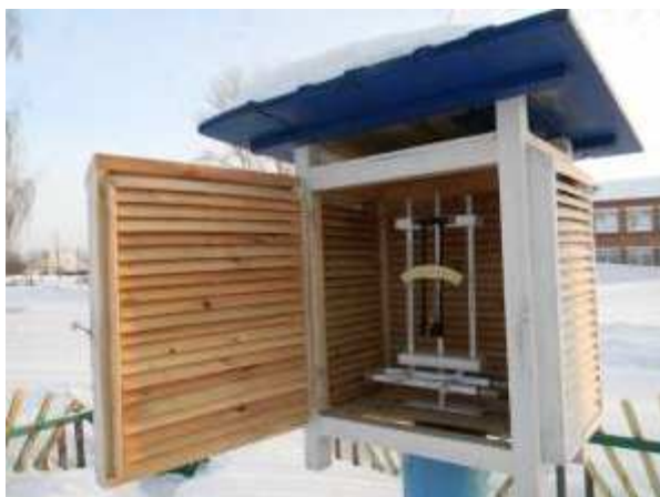
Рис 4.1. Установка приборов в психрометрической будке
