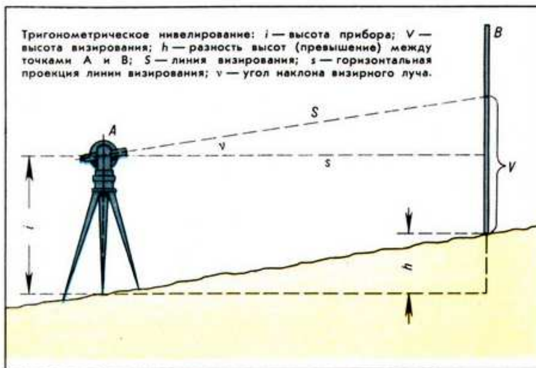
Рис 54 Схема тригонометрического нивелирования
