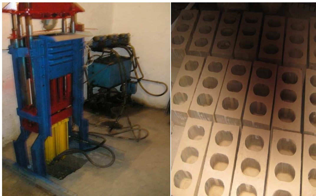
Рис. 2. Общий вид установки для производства крупноформатных керамических строительных блоков полусухим способом формования и образцы сырца отформованных блоков.
