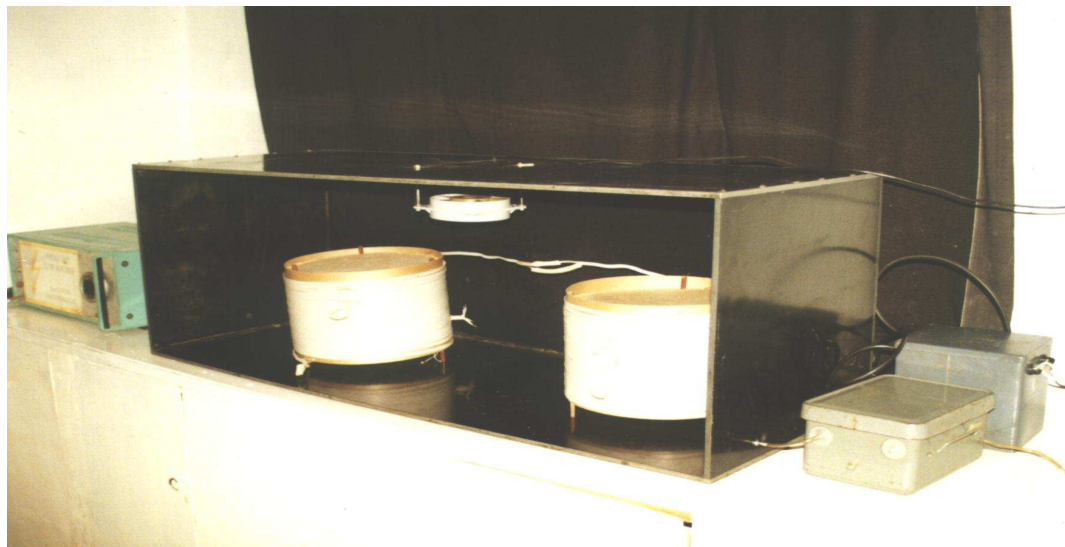
Рис. 15. Установка для изучения энергетических характеристик БР и наработки озона.
