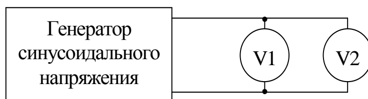
Рис.1. Блок-схема эксперимента по поверке вольтметра
